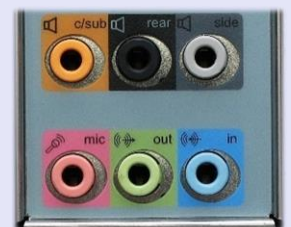
67. ábra: alaplapi jack csatlakozók. Minden alaplap esetében a rózsaszín jelzés jelzi a mikrofon bemeneti portot.
