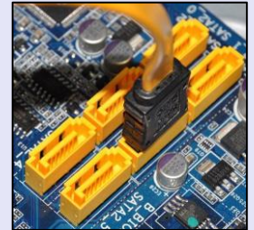
47. ábra: alaplapon található SATA portok (a képen sárga festéssel), és egy csatlakoztatott SATA kábel.
