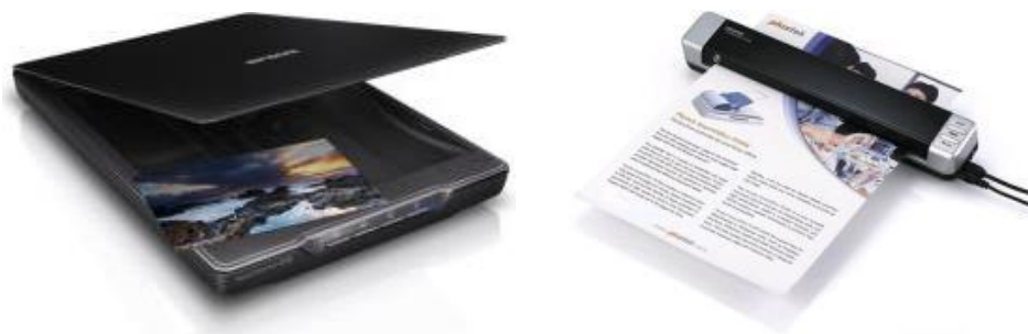
73. ábra: bal oldalon egy síkágyas szkennel, jobb oldalon egy dokumentumszkennel látható. Előbbinél a kép a tárgytartó üvegre kerül és az olvasó egység az üveg alatt halad végig. Utóbbi pedig nagy mennyiségű dokumentumok beolvasására lett kitalálva, a dokumentum halad végig a készüléken.
