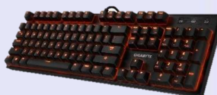
64. ábra: kifejezetten játékokra tervezett mechanikus billentyűzet háttérvilágítással
