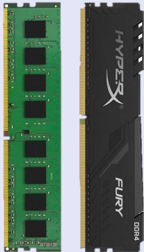
42. ábra: asztali számítógép RAM-ok. A jobb oldali változat hűtőbordákkal rendelkezik, így kevésbé melegszik.
