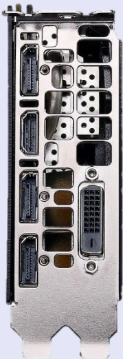
52. ábra: az 53. ábrán látható dedikált videokártya kimeneti portjai: 1 DVI, 1 HDMI, 3 DisplayPort. Felismered őket?
