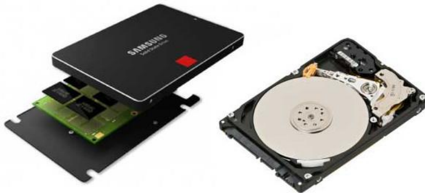
49. ábra: SSD (balra) és HDD (jobbra) hardverek belseje
