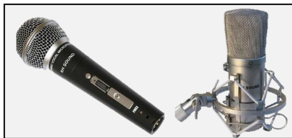
69. ábra: a két legelterjedtebb mikrofon fajta. Balra egy dinamikus , jobbra egy kondenzátoros mikrofon látható. Előbbit főleg énekhez, beszédre használják, utóbbit stúdiókban, felvételek készítésére.
