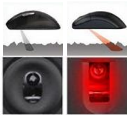
68. ábra: balra a lézeres, jobbra az optikai egér érzékelője látható
